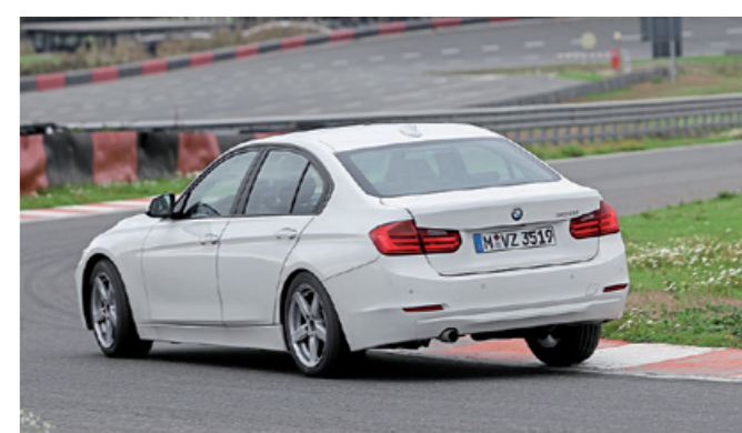
TROCKEN-HANDLING Auf dem 1880 Meter langen Rundkurs gilt es, im Grenzbereich drei möglichst identische Zeiten zu fahren. Außerdem bewerten wir auch hier die Fahrsicherheit
