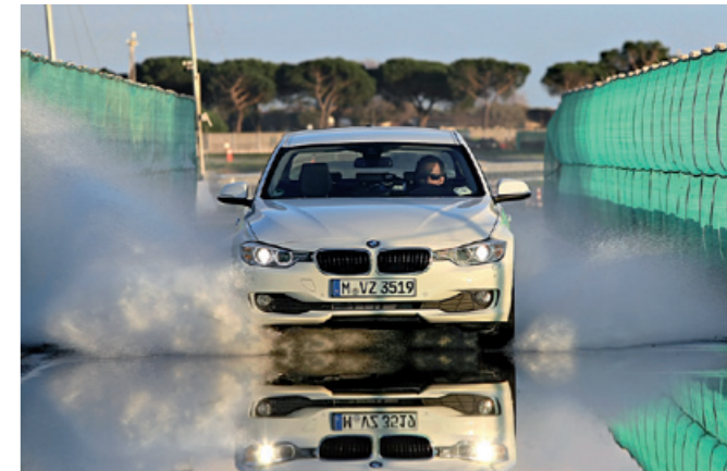
AQUAPLANING Sensible Mess-Sensoren ermitteln, bei welchem Tempo der Reifen das Wasser im sieben Millimeter tiefen Becken nicht mehr verdrängen kann und aufschwimmt
