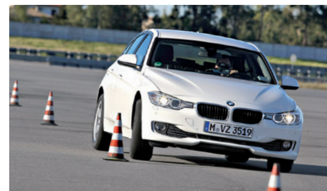
SLALOM In der 180 Meter langen Pylonen-Gasse fahren wir permanent an der Haftgrenze. Bewertet wird objektiv (Durchschnittsgeschwindigkeit) und subjektiv (Fahrsicherheit)
