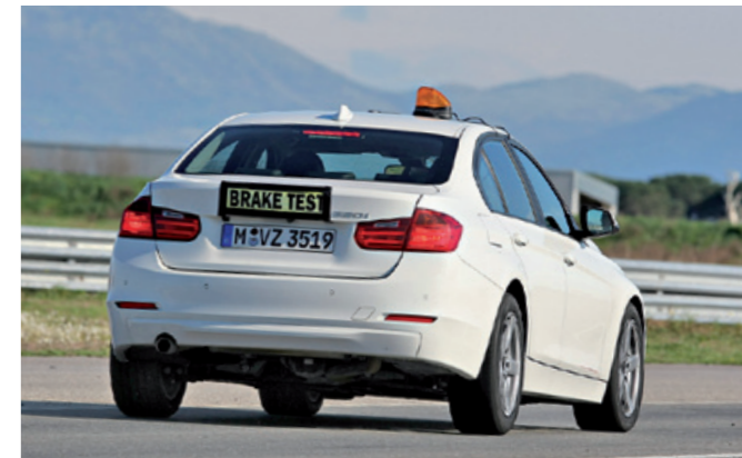
TROCKEN-BREMSEN Die Schnittmenge aus zehn Vollbremsungen aus 100 km/h bis zum Stillstand ergibt den Bremsweg, den das Hightech-GPS auf den Zentimeter genau anzeigt
